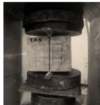
Gambar 3. Pengujian kuat tarik belah
