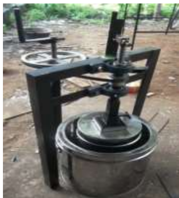
Gambar 8 Teknologi tepat guna berupa usulan alat penghancur buah kolang-kaling mobile dan portable dan akan disumbangkan kepada mitra
